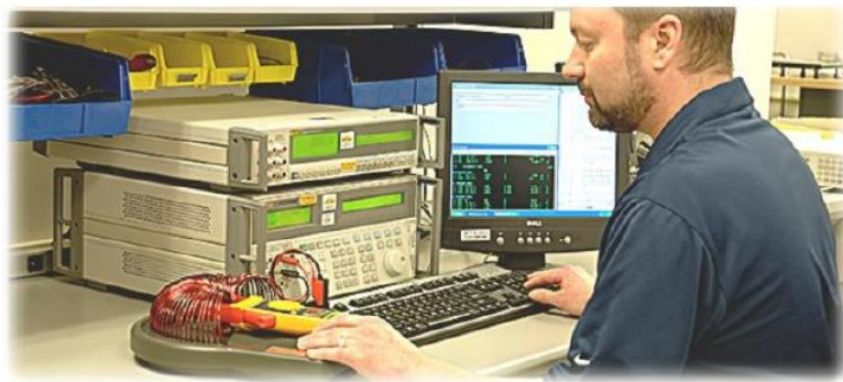
รูปที่ 1.5 การปรับเทียบมาตรฐานเครื่องมือวัด ที่มา : พันธุ์ศักดิ์ พุฒิमानิตพงศ์. เครื่องมือวัดไฟฟ้าและอิเล็กทรอนิกส์. สำนักศูนย์ส่งเสริมอาชีพ, 2557. หน้า 13.
